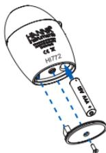
3. Retire la batería vieja, reemplácela con una nueva batería AAA de 1.5 V, insertando primero el extremo negativo.
