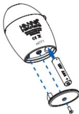
3. Retire la batería usada y reemplácela por una nueva AAA de 1.5 V, insertando primero el extremo negativo.
