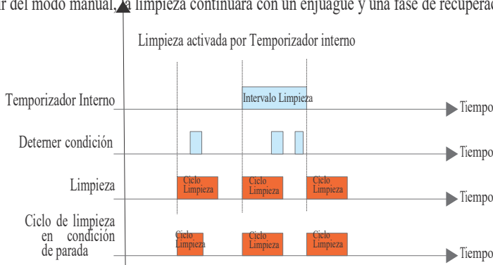
Figura 54: Limpieza Final, Condición de Parada
