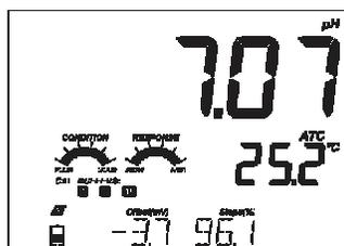
El pH es desplegado en la 1ª línea del LCD y la temperatura en la 2ª línea del LCD. Utilizando las flechas, fecha, hora, estado de la batería y compensación con pendiente pueden ser visualizadas en la 3ª de LCD. Si la lectura está fuera del rango de medición, el valor de escala completa más cercano se mostrará parpadeando en la 1ª línea de LCD.
