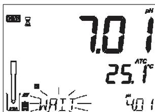
El valor calibrado será desplegado en la primera línea de la pantalla LCD y el segundo valor de buffer esperado en la 3ra línea de la pantalla LCD.
