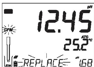
**Nota:** Cada vez que se confirma un buffer, los nuevos datos de calibración reemplazan los datos antiguos para el buffer o para cualquiera cerca del buffer en una proximidad de  $\pm 0, 2$  pH. Si el buffer actual no tiene datos anteriores almacenados y la calibración no ha usado cinco buffers, el buffer actual será agregado a la calibración existente. Si la calibración existente está llena, el instrumento solicitará cual buffer reemplazar
