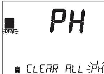
Mientras el tipo de medición y los estados de mensajes están parpadeando "LOG RECALL", presione CLR. "CLEAR ALL" y el tipo de medición será desplegado parpadeando con la etiqueta CFM. Presione CFM.
