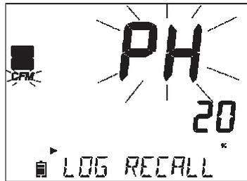
Presione la tecla RCL. El tipo pH, CE, o O.D. comenzaran a parpadear. Utilice ► para seleccionar el parámetro de medición deseado del registro de datos a ser borrado.
