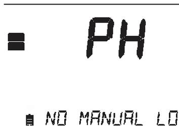
Si no existen datos registrados para el rango de medición seleccionado, el instrumento muestra los siguientes mensajes (ejemplo para el rango de pH):
