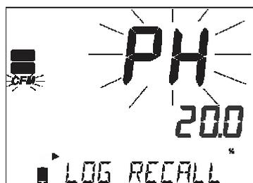
Si no está conectado un sensor o sonda, utilice la flecha ► para seleccionar el tipo de medición deseado. Presione CFM para desplegar esos registros.
